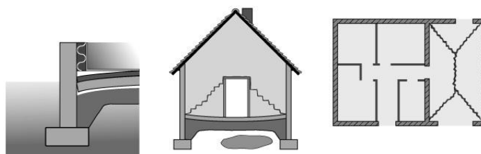
Figure 36 : Affaissement de dallage
