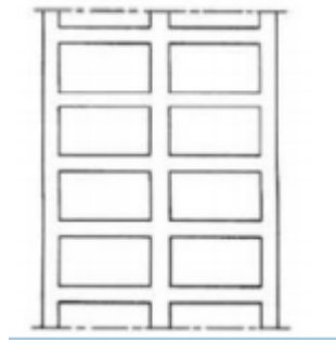
Figure II.1:Ossature en portiques (à deux travées) [9].
