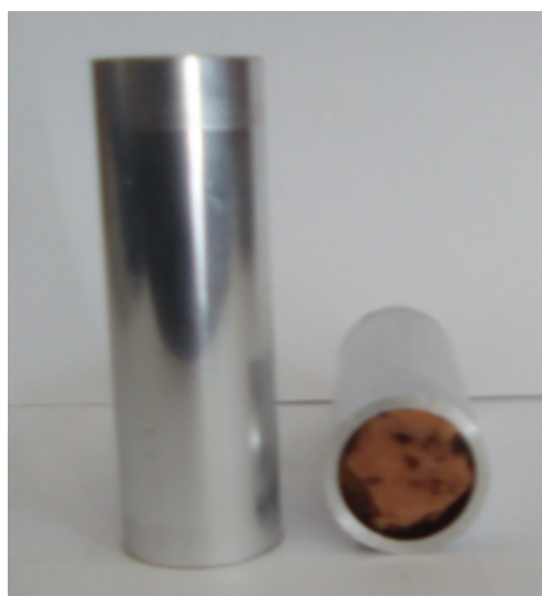
Figure 2.44 – Dimensions de l'éprouvette tubulaires renforcés avec liège naturel.
