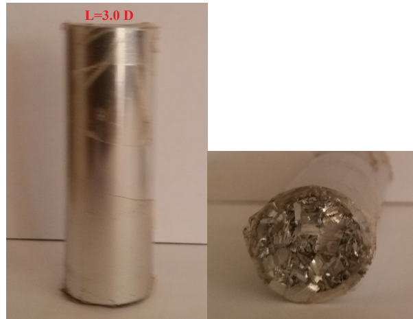
Figure 2.37 – Dimensions des éprouvettes tubulaires renforcées par des copeaux.
