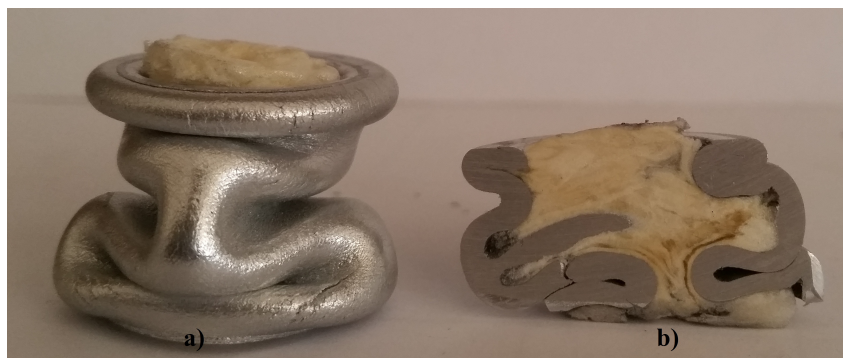
Figure 2.52 – Eprouvettes renforcés avec une mousse : a) avant déformation, b) après déformation et vue de coupe.
