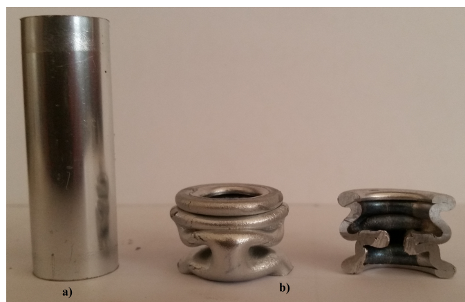
Figure 2.32 – Eprouvette de compression : a) avant déformation, b) après déformation et vue de coupe
