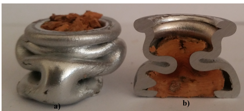
Figure 2.46 – Eprouvettes renforcés avec le liège : a) avant déformation, b) après déformation et vue de coupe.
