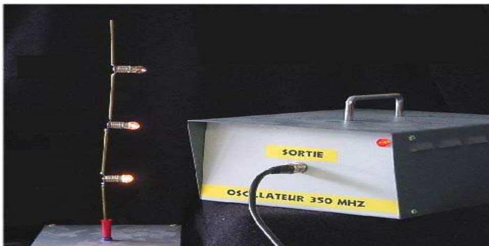
Figure I- 2 : Illustration de l'intensité du courant dans un brin.
