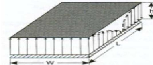
Figure II-6 : Distribution de la composante verticale  $E_z$  du champ électrique entre le patch et le plane de masse dans le mode fondamental de l'antenne ( $L$  longueur résonante et on attaque avec la ligne d'alimentation sur le côté  $W$ ).
