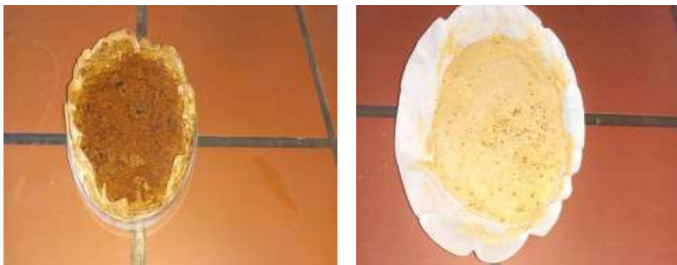
Figure 15: cellulose avant et après traitement à l'eau de javel
