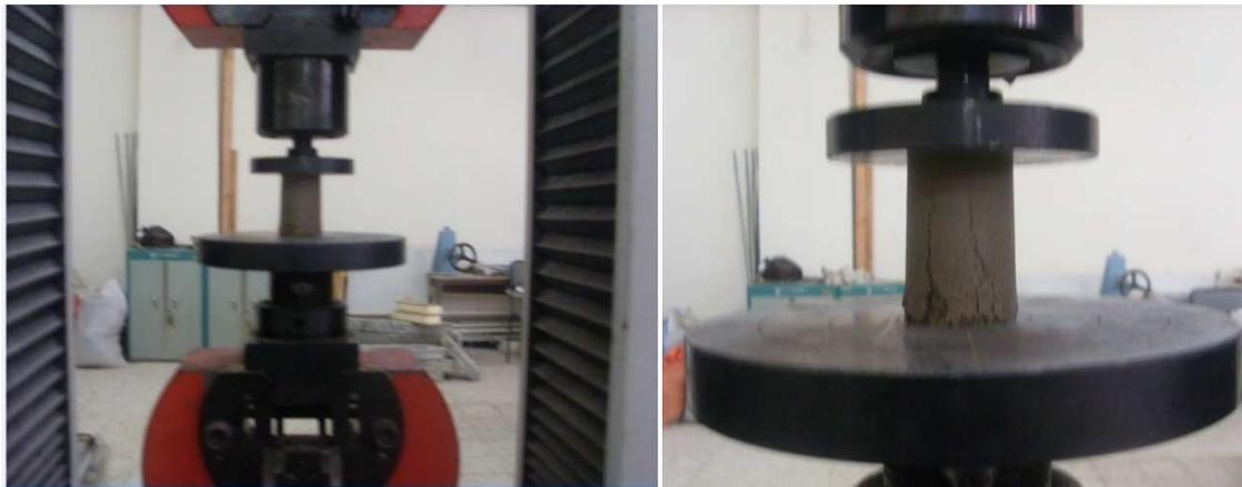
**Figure IV.12 Essai de compression simple**
