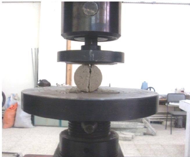
Figure IV.16 Essai d'écrasement en traction brésilienne (par fendage)
