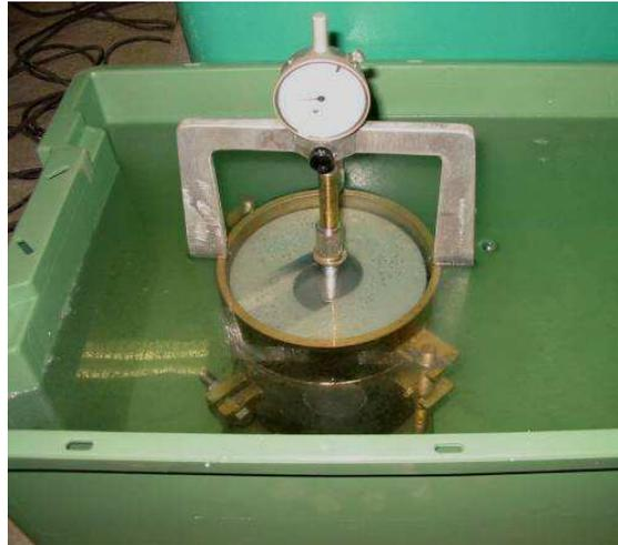
**Figure IV.6 Immersion de l'éprouvette pour la détermination de ICBR et de G.**
