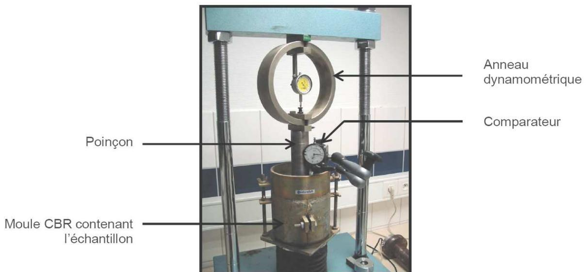
**Figure III.18 Dispositif de l'essai de poinçonnement**
