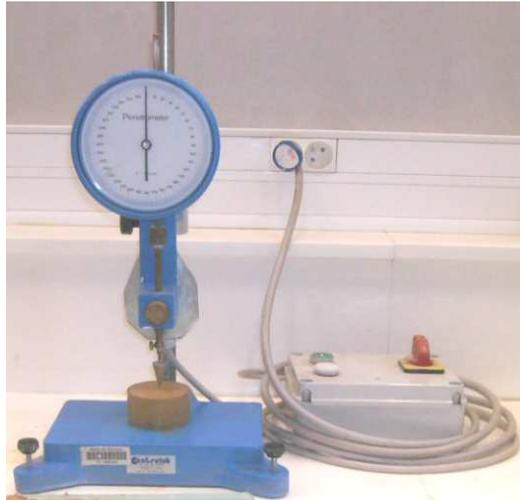
Figure III.8 Appareil du cône de pénétration
