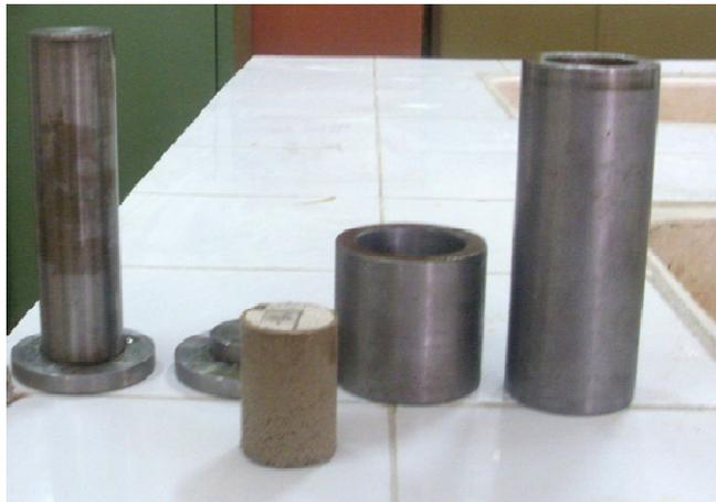
**Figure IV.5 : Moule pour confection des éprouvettes (compression et traction)**
