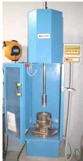
**Figure III.16 Appareil CBR : compacteur automatique Proctor-CBR**
