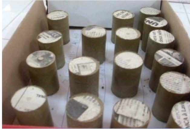
**Figure IV.11 Conservation des éprouvettes**
