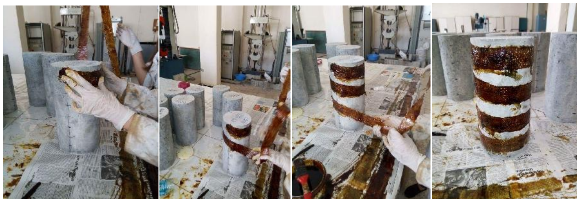
Figure. III.21 : Collage de composite sur la face externe du cylindre.
