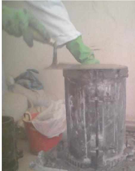
Figure. III.6. Arasement des surfaces des éprouvettes.
