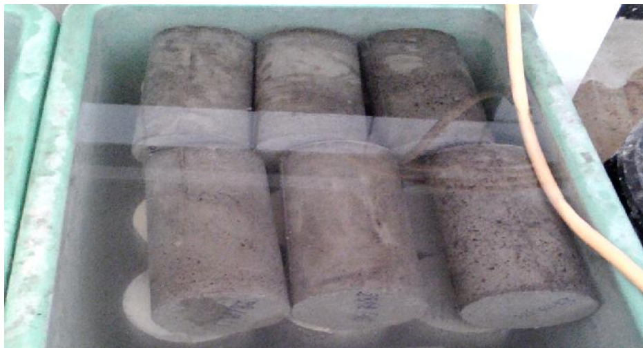
Figure. III.8. Cure d'hydratation des éprouvettes en béton.
