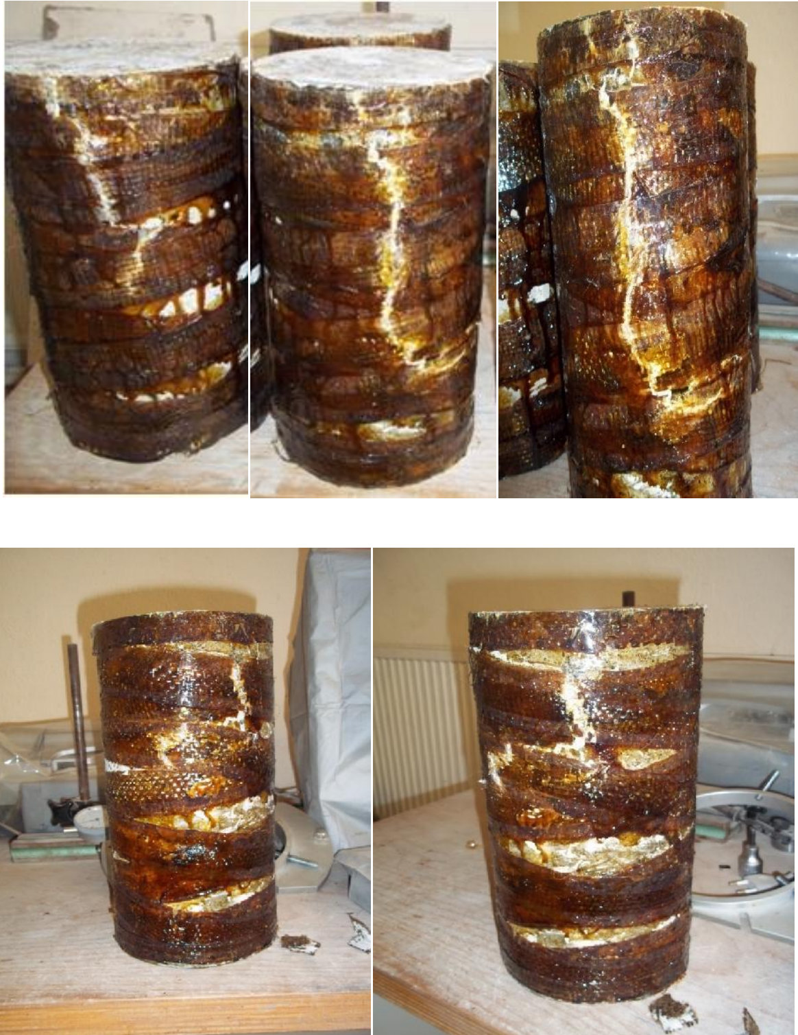
Figure. VI.5 : Mode de rupture des éprouvettes confinées avec un PRFV
