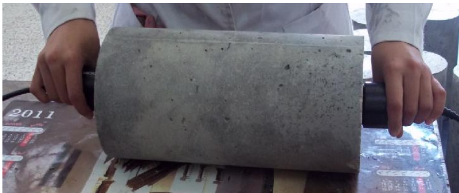
Figure. III.16 : auscultation dynamique sur une éprouvette cylindrique
