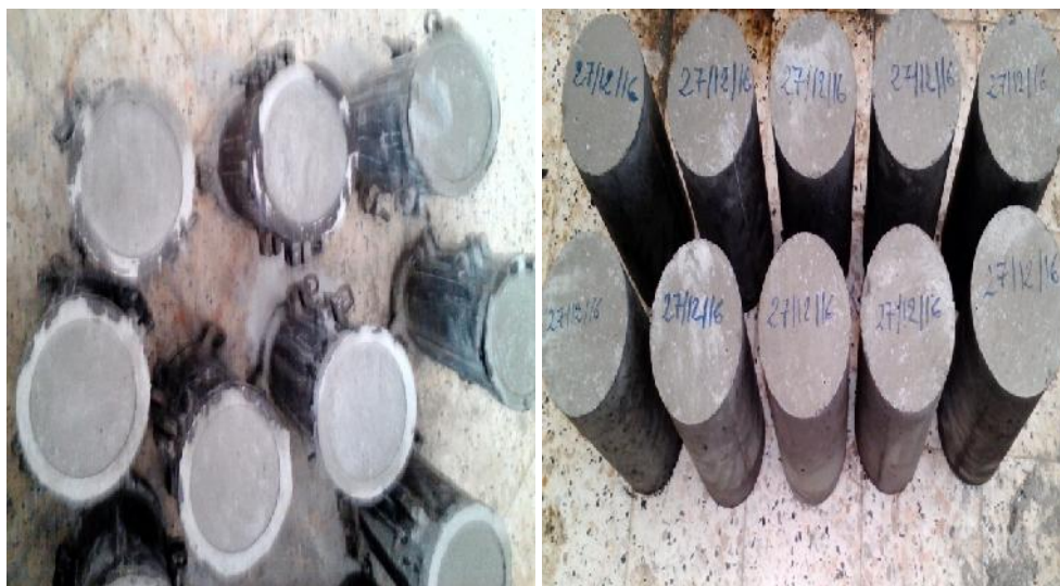
Figure. III.7. Démoulage des éprouvettes.
