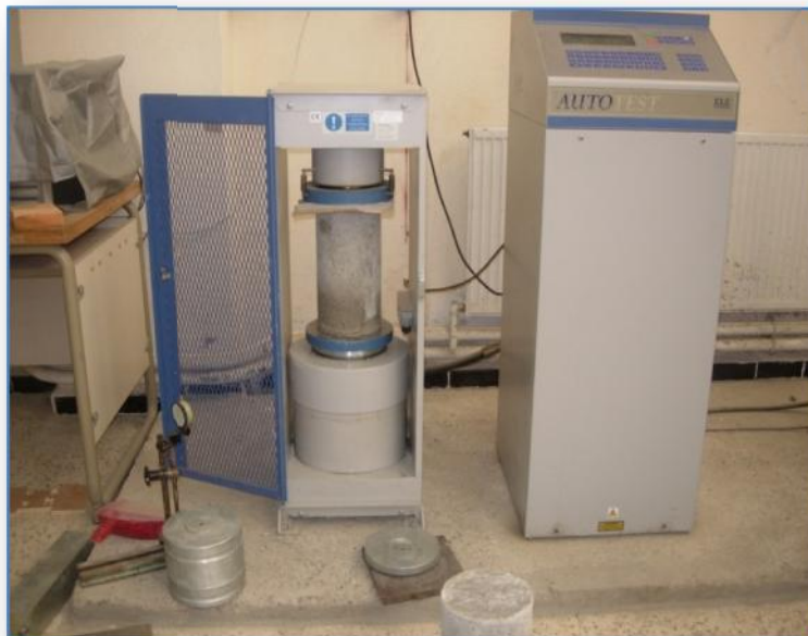
Figure. III.12 : Epreuve soumise à la compression.
