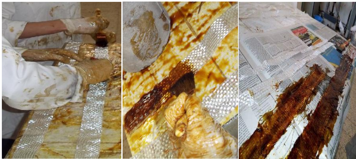
Figure. III.20 : application de la résine sur le composite.
