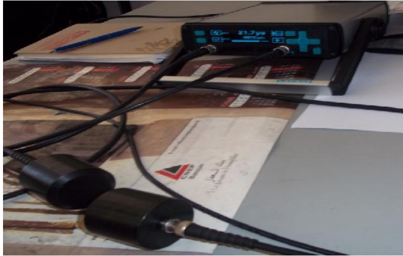
Figure.III.15 : appareil d'auscultation sonore
