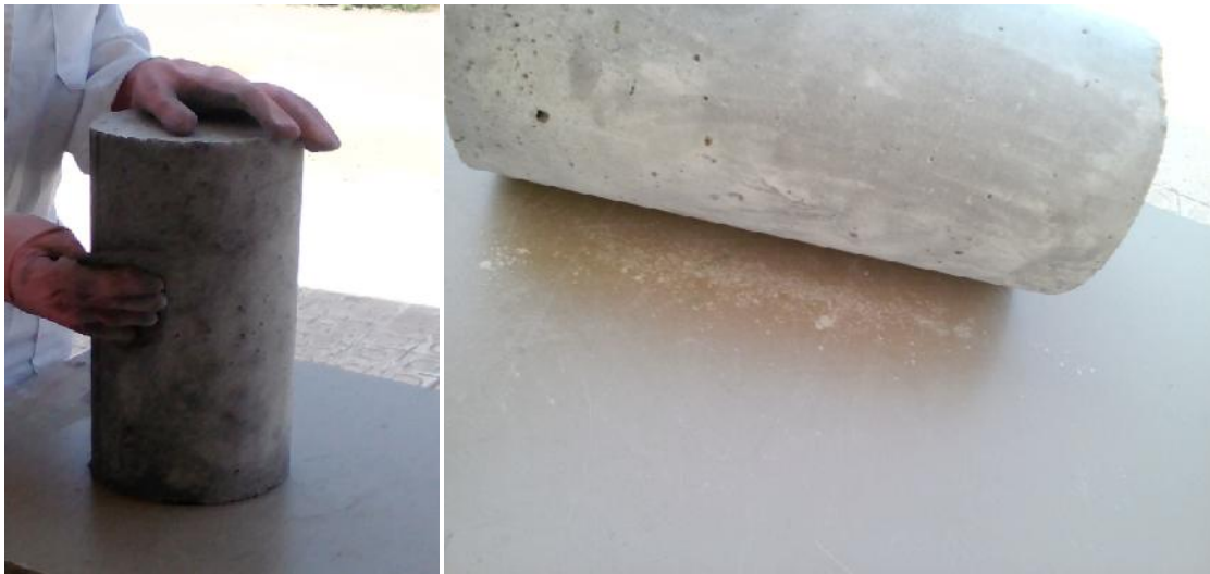
Figure. III.9 : traitement de la surface latérale du cylindre en béton.
