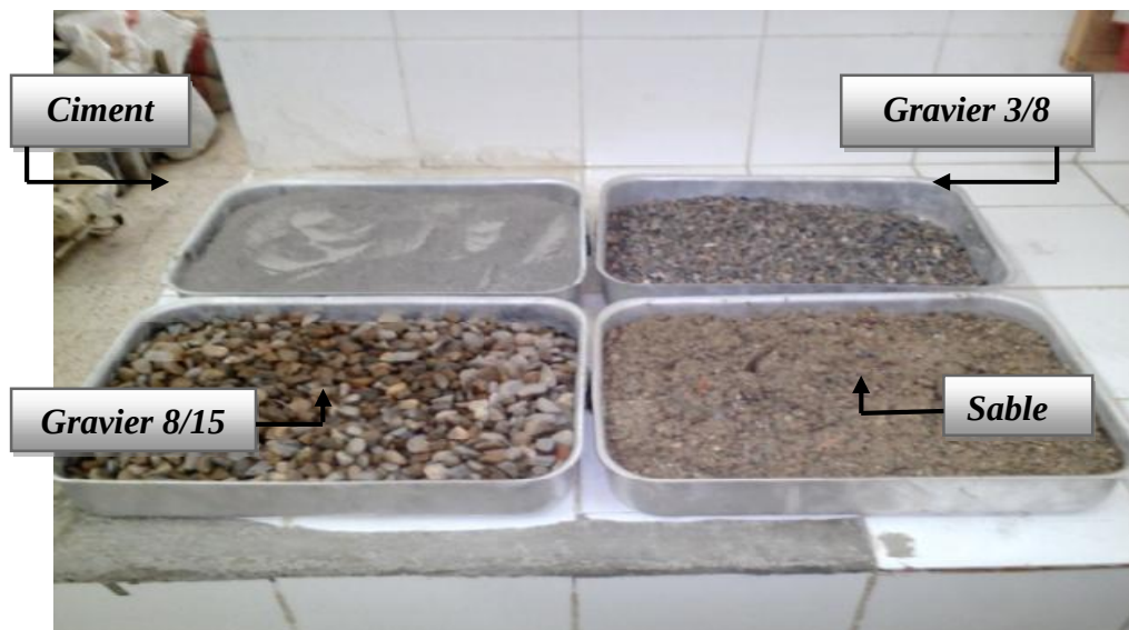
Figure. III.1 : Différents constituants du béton
