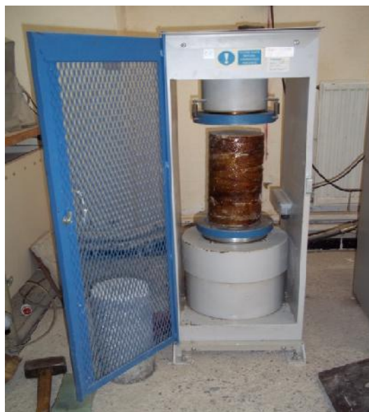
Figure. III.23 : Eprouvette confinée soumise à la compression uniaxiale.
