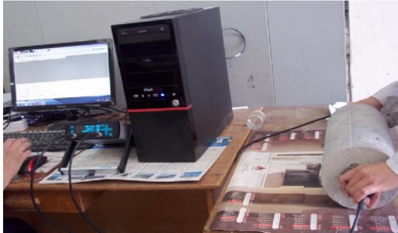
Figure. III.17 : Enregistrement des mesures de l'ultrason sur un ordinateur
