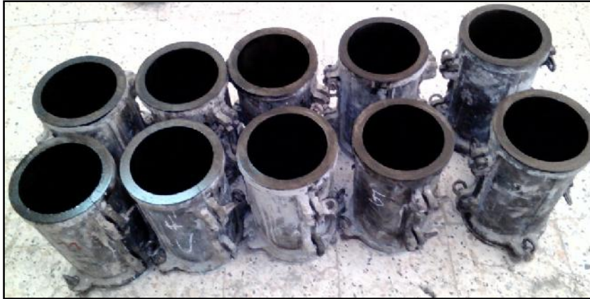
Figure III.4: Moules métalliques de dimensions ( \varnothing 150 \text{ mm} \times 300 \text{ mm} ).
