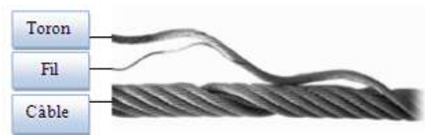
Figure 41 : Eléments constitutifs d'un câble métallique.
