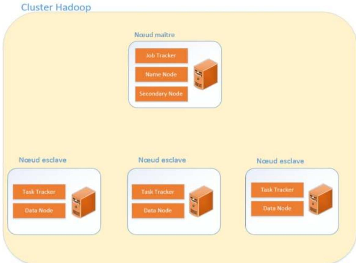
**Figure II.1: Architecture d'un Cluster Hadoop**
