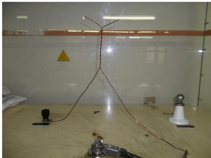
Figure IV.9. Echantillon au cours de l'essai de claquage.
