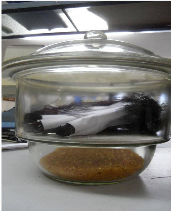
Figure IV.7 : Echantillons en cours de conditionnement dans un dessiccateur.
