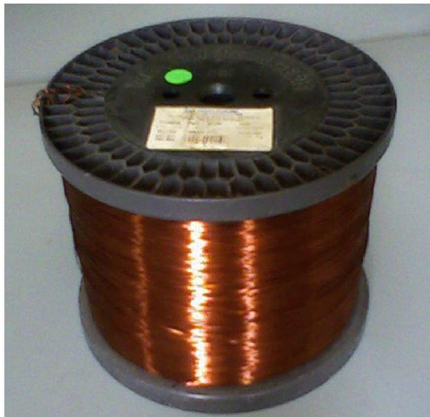
Figure IV.1. Bobine de fil de cuivre émaillé de classe C
