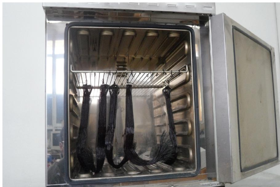
Figure IV.6 : Echantillons vieillis avec un changement de couleur.
