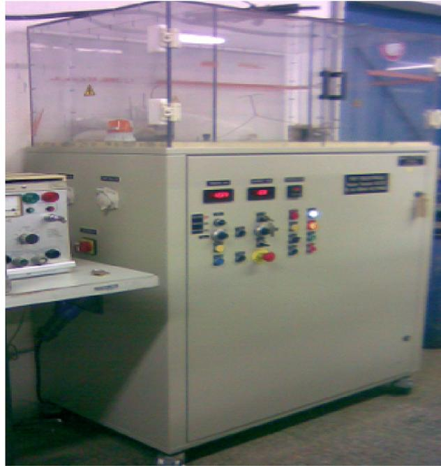
Figure IV.8. Générateur de haute tension utilisé pour les essais de claquage.
