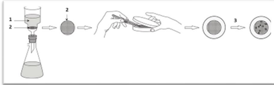
Figure 24. Méthode pour la recherche des coliformes par filtration sur membrane (la norme ISO9308-1).
