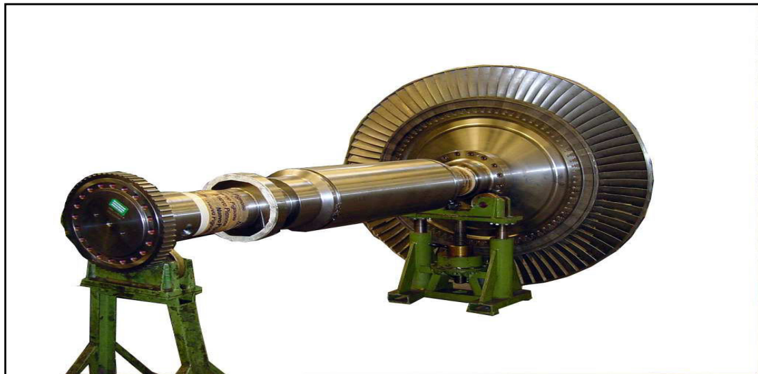
Fig.3.12 : Rotor de la turbine basse pression (BP)
