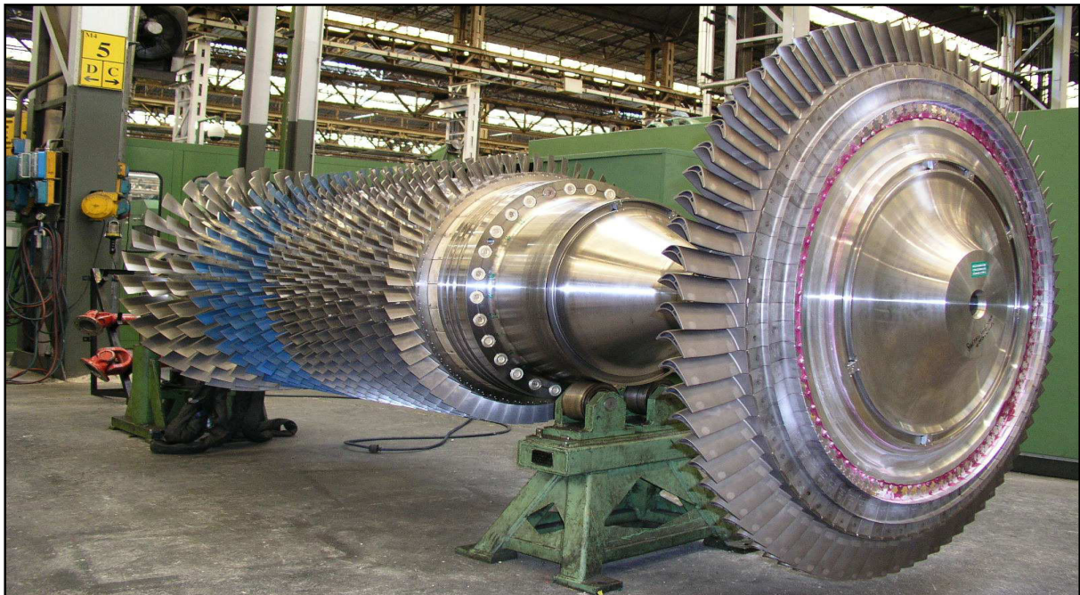
Fig.3.2 : Rotor du compresseur et la roue HP
