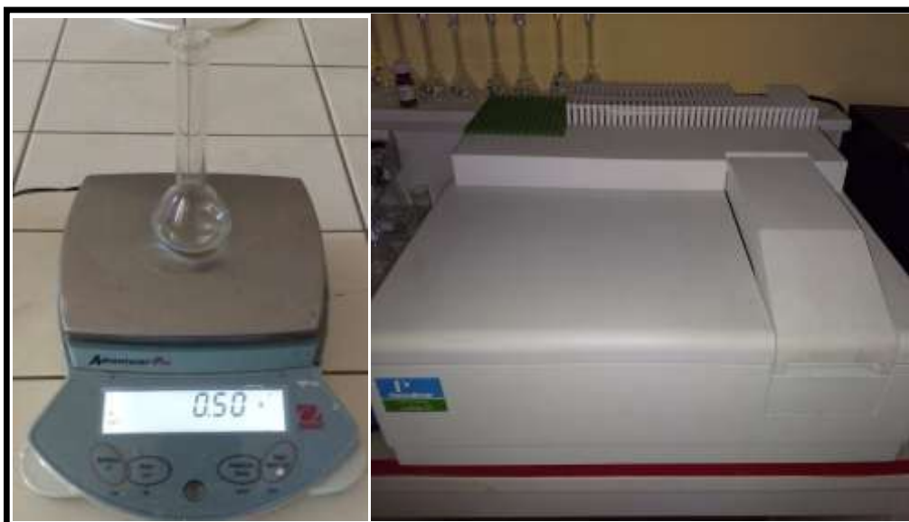
Figure 14 : Détermination de l'absorbance dans l'ultra-violet.
