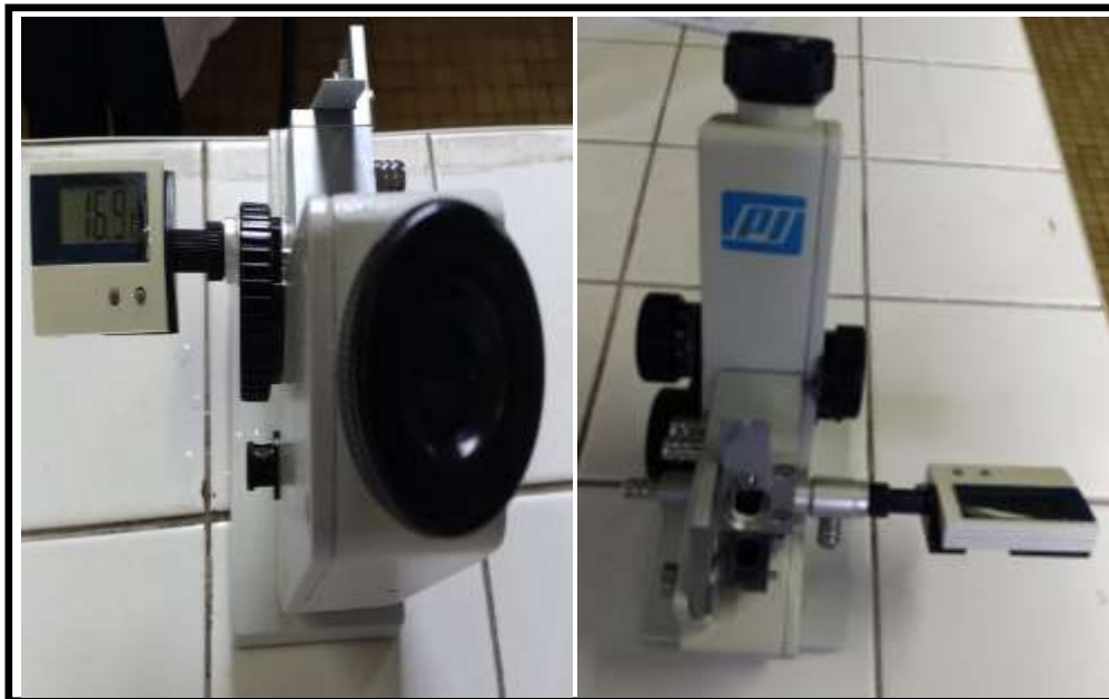
Figure 15 : Détermination de l'indice de réfraction.
