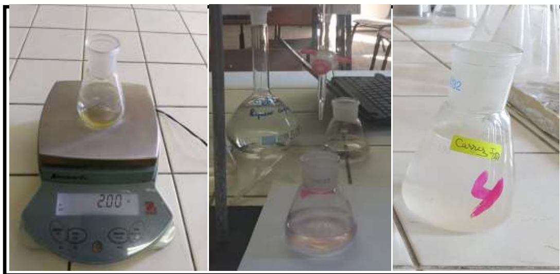
Figure 12 : Détermination de l'indice de peroxyde.
