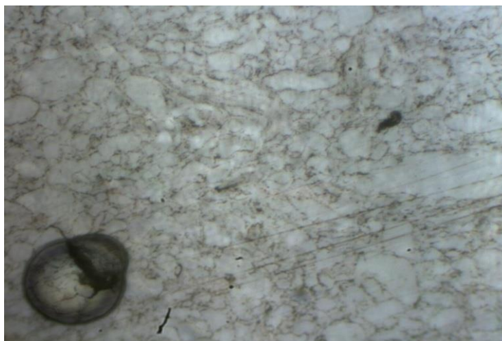
Figure 45 : Microstructure de la pastille avant le frittage obtenue avec un microscope optique (zoom x400)
