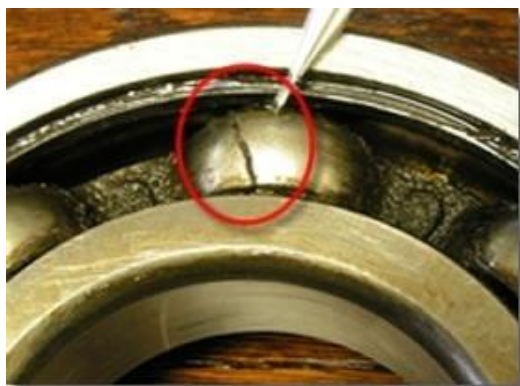
Figure II.14 : Exemple d'un défaut de roulement
