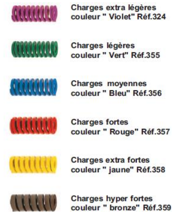
Fig 53 : Classification des ressorts par couleur
