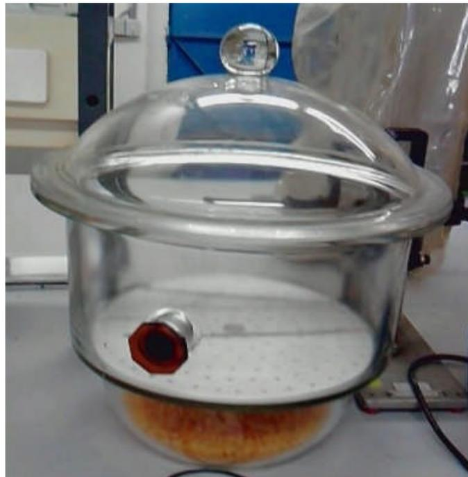
Figure IV.3. Dessiccateur employé pour le conditionnement des éprouvettes.
