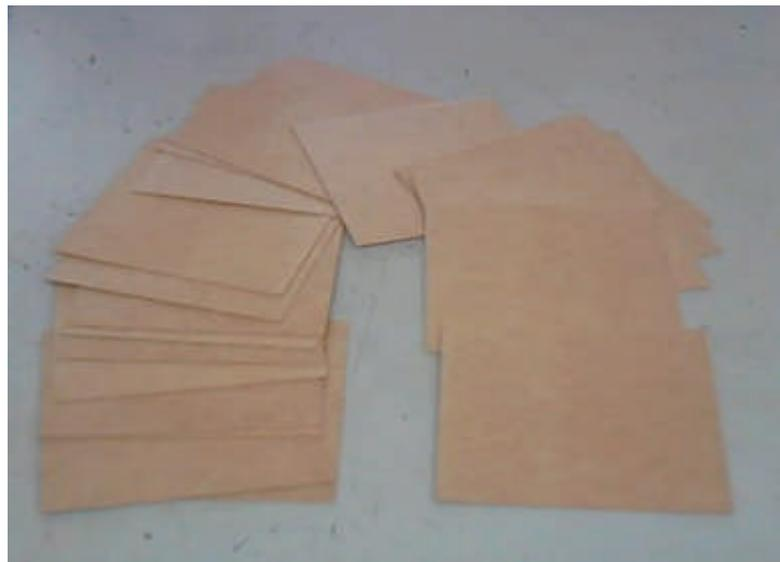
Figure IV.1. Eprouvettes de papier presspahn à l'air libre du laboratoire
