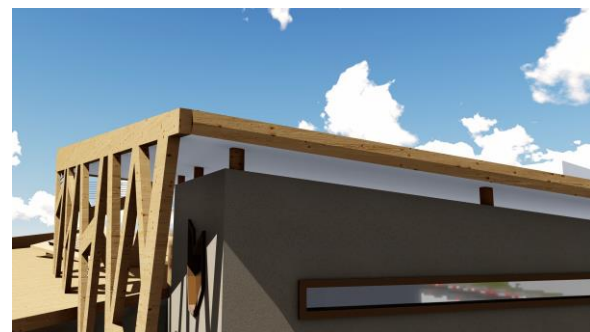
Figure 57: La double toiture. Source : Auteurs .
