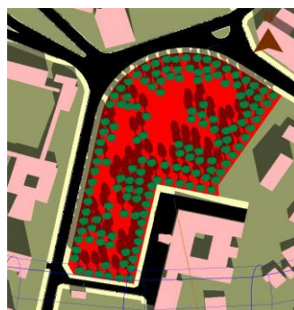
Figure 74: Ensoleillement de site d'intervention le 21 décembre à midi. Source : Logiciel ECOTEECT. Utilisé par auteurs.
