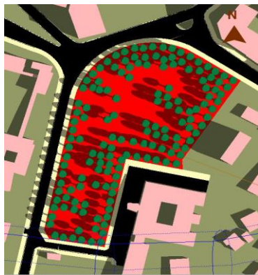
Figure 77: Ensoleillement de site d'intervention le 21 mars à 9h. Source : logiciel ECOTECT. Utilisé par auteurs.
