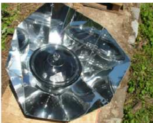
Photo d'un cuiseur thermique (four solaire) pour cuire les aliments
