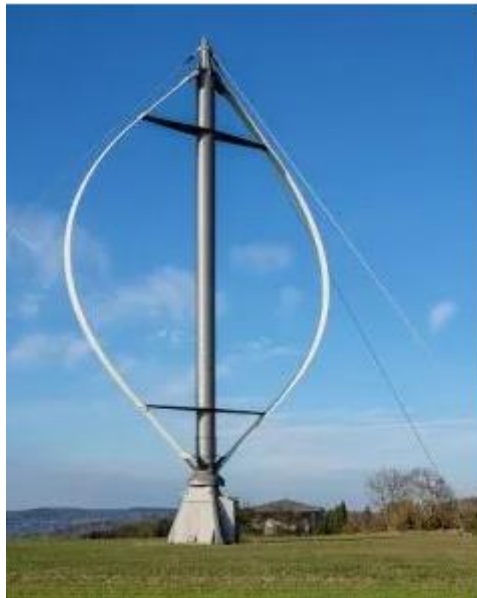
Figure 3 : l'éolienne à axe verticale à rotor darrieus. [10]
