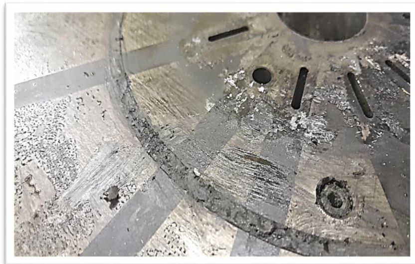
Figure II-16: les événements d'air endommagés par la graisse de démoulage solidifiée.
