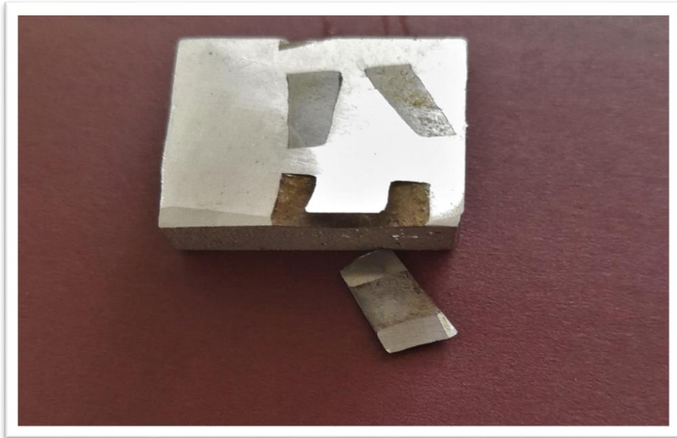
Figure II- 2: arrachement des défauts contenus dans l'aluminium.
