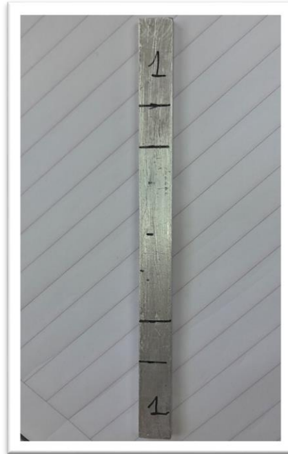
Figure II- 30 : Éprouvettes usinées de section transversale
