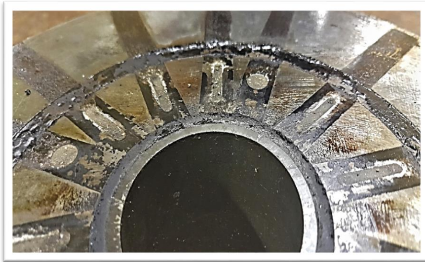
Figure II- 15 : la présentation des événements d'air sous forme de rainure.
