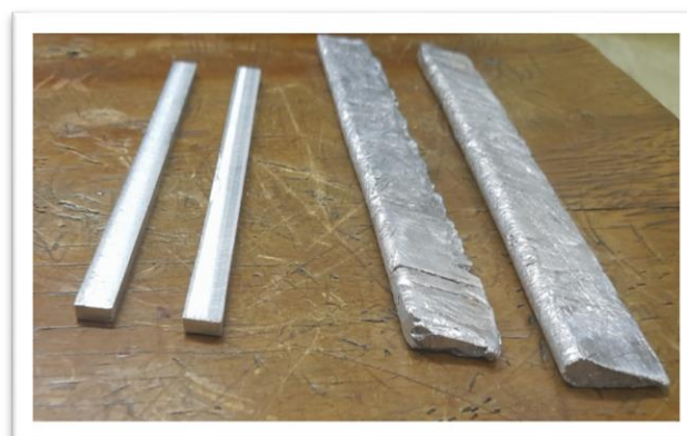
Figure II- 20: barres avant et après usinage.
