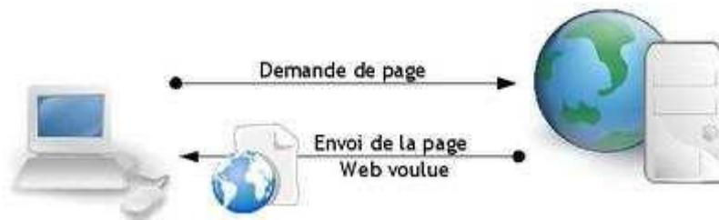
**Figure III.2.A : fonctionnement d'un site web statique**
