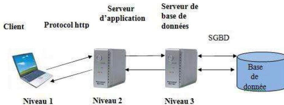
Figure V.2.B : Architecture client-serveur à trois niveaux.
