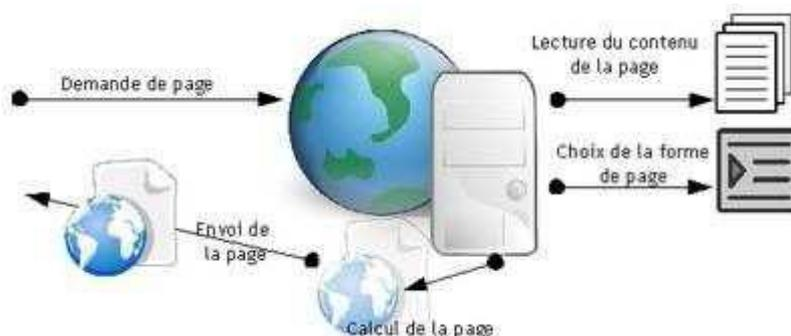
**Figure III.2.B : fonctionnement d'un site web dynamique**
