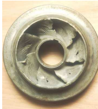
Figure (V.4) : Photo illustrant le phénomène de cavitation sur des aubes d'une pompe centrifuge
