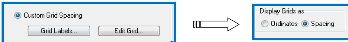
On introduit les distances des trames suivant X-X et Y-Y
