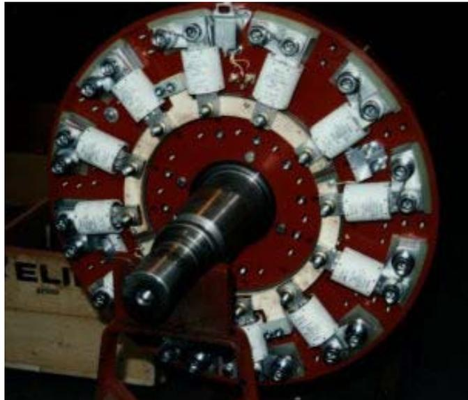
**Figure III.7 : plateau de diode incorporé sur la roue polaire de l'alternateur**
