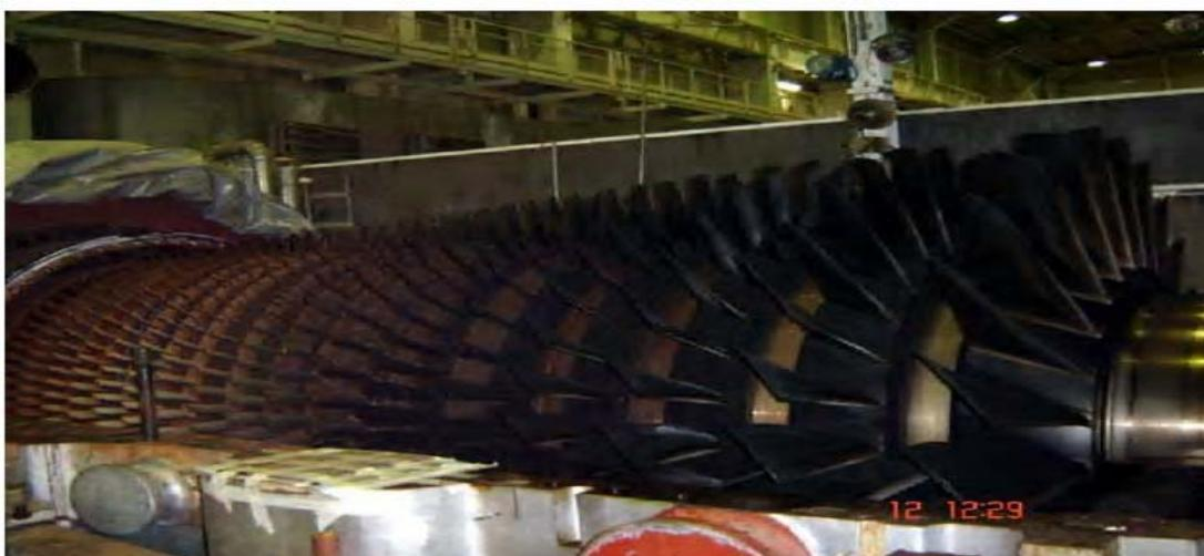
**Figure III.4 : Vue interne du compresseur de la turbine à gaz V94.3 de la centrale d'EL HAMMA II**
