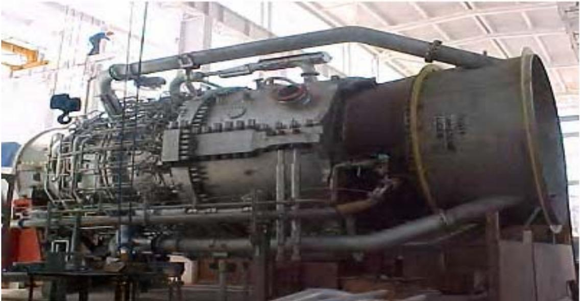
**Figure I.2 : Vue externe de la turbine à gaz V94.3A de la centrale
