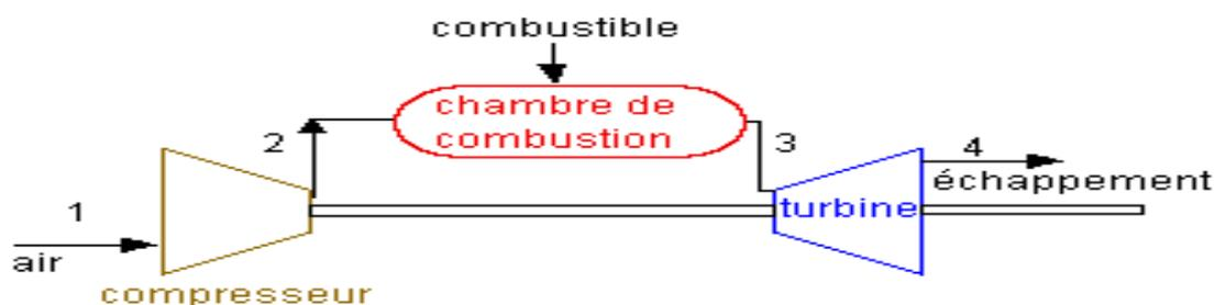
**Figure III.1 : Schéma d'un cycle de base d'une turbine à gaz**
