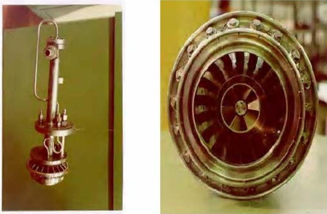
**Figure III.7 : Les brûleurs hybrides Simens de la chambre de combustion de la turbine à gaz V94.3A de la centrale d'El HAMMA II**
