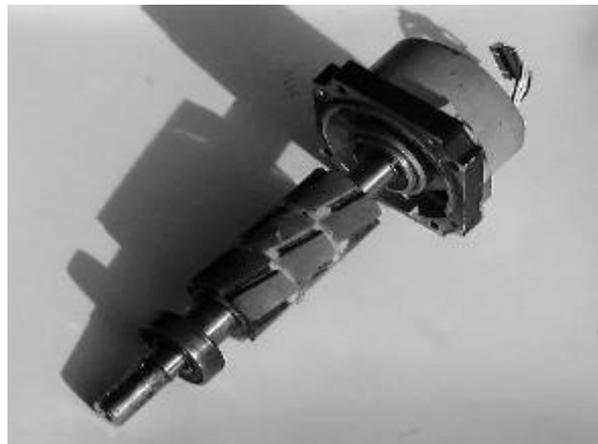
**Figure III.5 : Rotor à aimant permanent**
