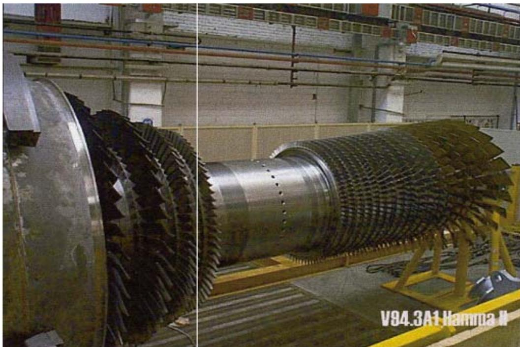
**Figure III.10 : Vue interne du rotor de la turbine à gaz V94.3A de la centrale d'El HAMMA II**
