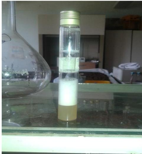
**Figure III.10.** La mousse qui se forme en mélangeant le solide et l'eau
