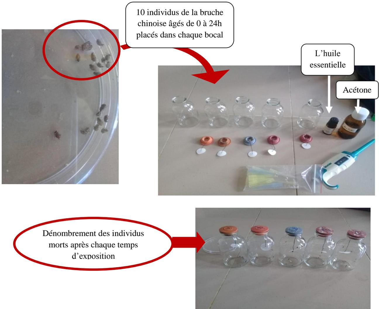
**Figure 18.** Dispositif expérimental du test par inhalation sur les adultes de *C. chinensis* traités à l'huile essentielle de la menthe pouliot (**Originale, 2020**).
