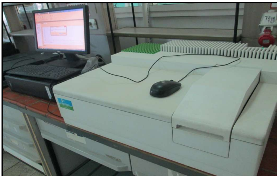
Figure 16 : Spectromètre UV-VIS de type Perkin Elmer UV/VIS Spectrometer Lambda 25.
