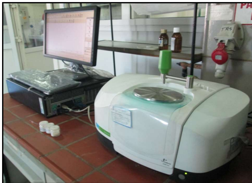
Figure 15: Spectromètre FT-IR Perkin Elmer Spectrum Two.
