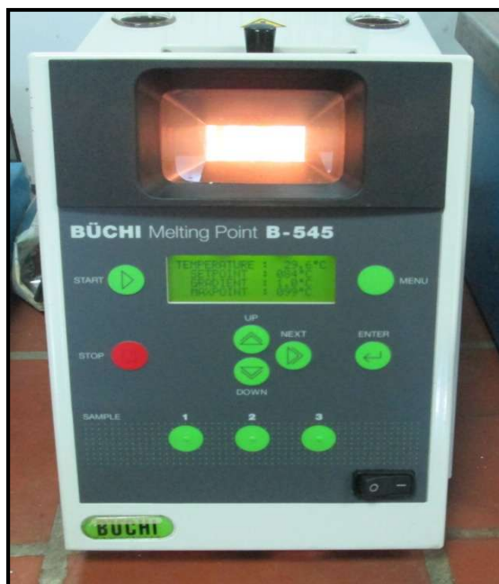
Figure14 : Fusiomètre de type BÜCHI melting point B545.
