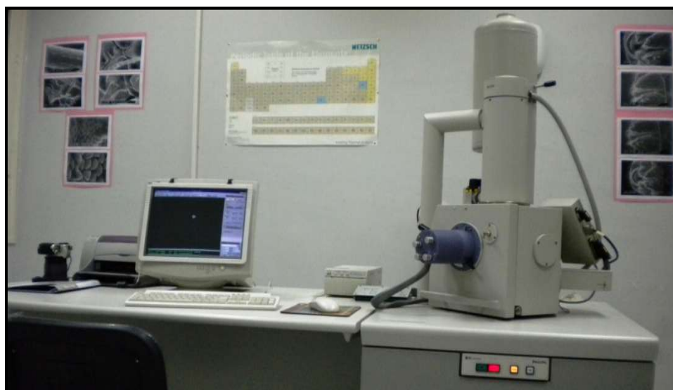
Figure 13: Microscope électronique à balayage Philips ESEM XL-30 couplé à un système complet de microanalyse EDS.
