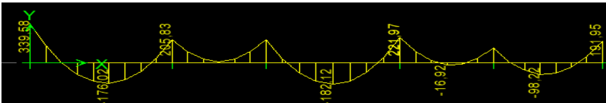
Figure VI.7. Diagramme des moments fléchissant à ELU en KN.m
