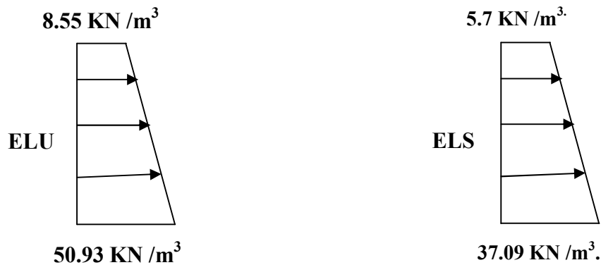
Figure VII.3 : Diagramme des contraintes.
