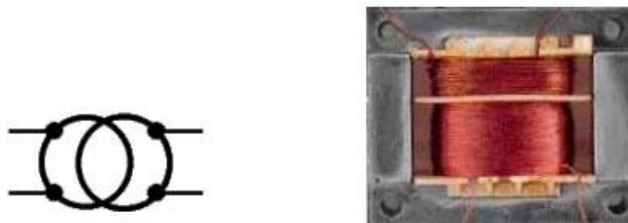
Figure II.6 : photo illustrant un transformateur
