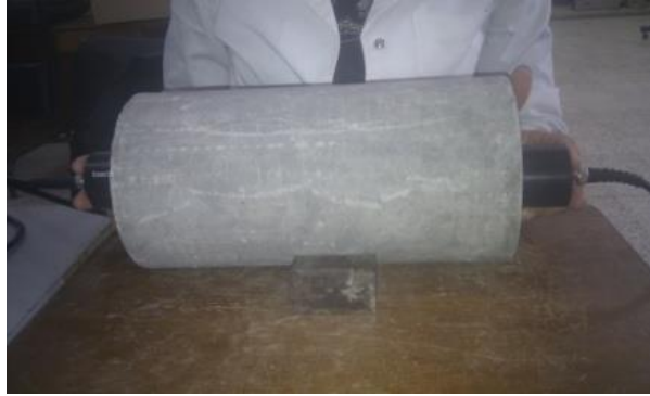
Figure II. 16: Mesure de vitesse de propagation des ondes ultrasonique.
