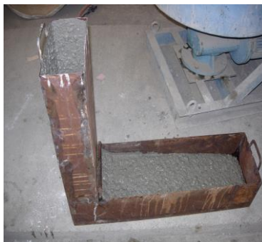
Figure II. 12: Photo descriptive de l'essai de la boîte en L
