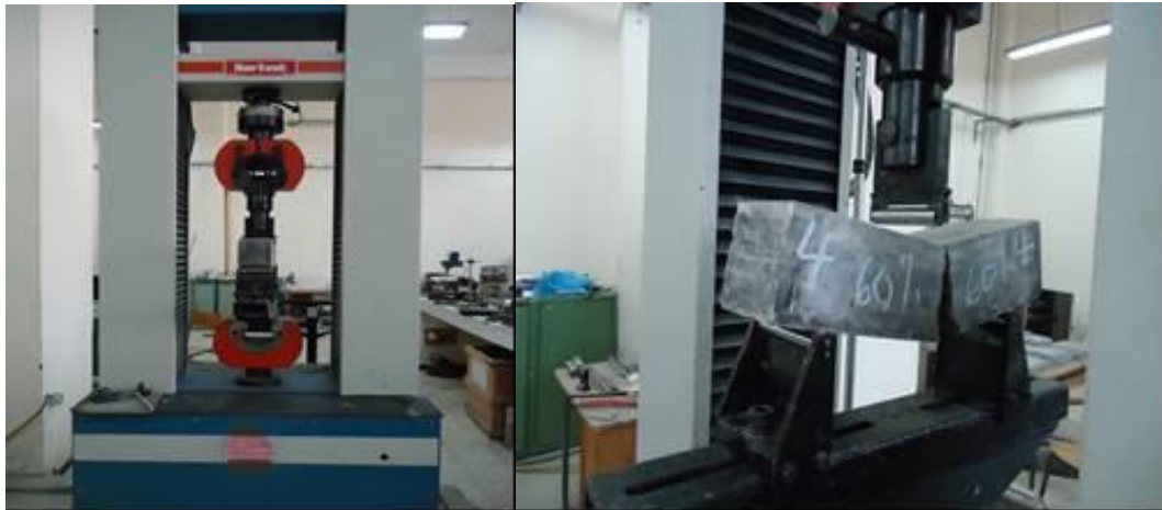
Figure II. 14: La presse utilisée; Rupture de l'éprouvette.
