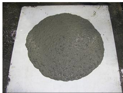
Figure I. 1: Test d'étalement d'un BAP.
