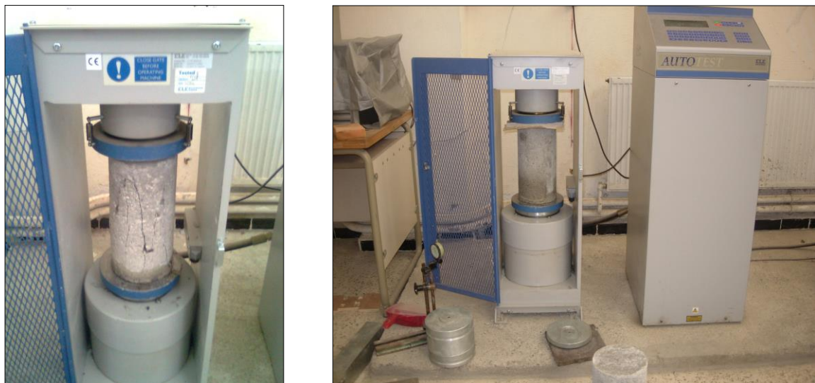
Figure II. 13: Rupture de l'éprouvette ; La presse utilisée.
