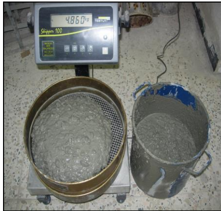
Figure II. 11: Photo descriptive de l'essai de stabilité au tamis (le tamis est de 5 mm).
