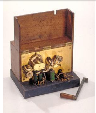
FIG 5 : chronographe (Gautier) du grand cercle méridien. Marc Heller © Observatoire de la Côte d'Azur
