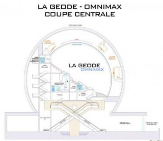
FIG 122 : Coupe de la salle du planétarium de la géode
