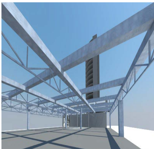
Figures134,135 : Vues 3d de l'ossature de la partie conçue en structure tridimensionnelle
