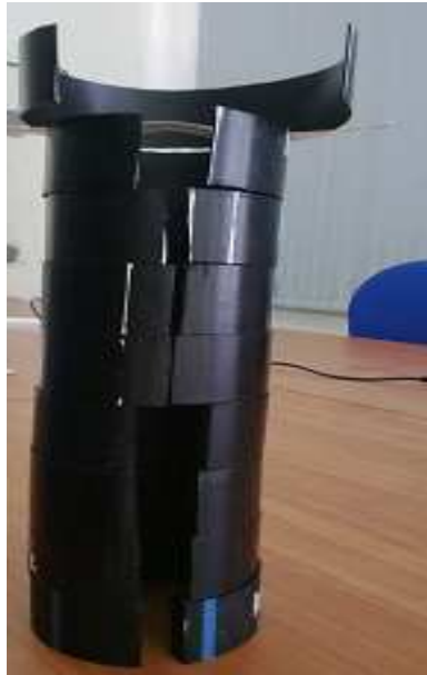
Fig 47-a) : éprouvettes extraies de tube de diamètres 125 mm
