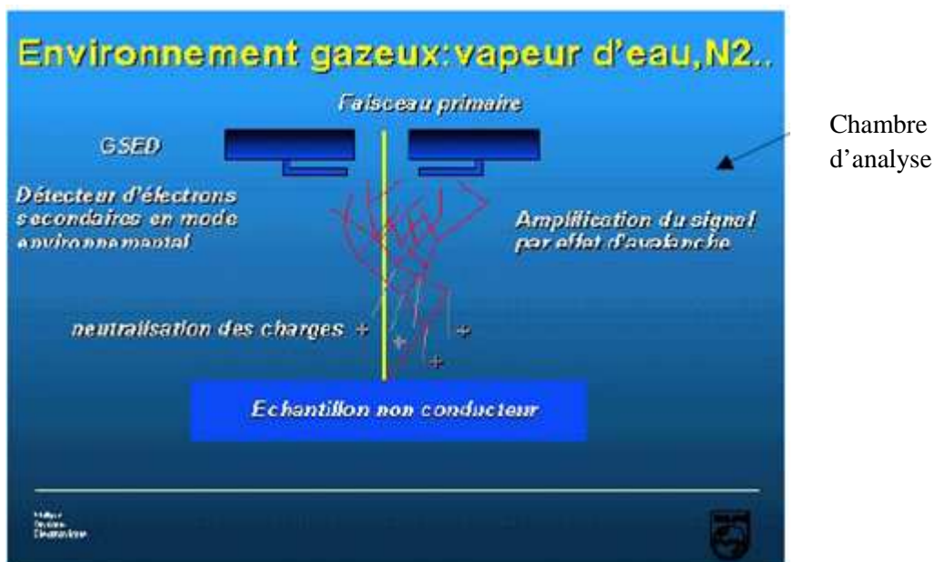
Fig 30 Description de la chambre d'analyse et son détecteur GSED d'un MEB [23].
