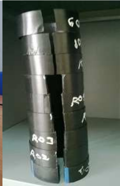
Fig 47-b) : éprouvettes extraies de tube de diamètres 90 mm
