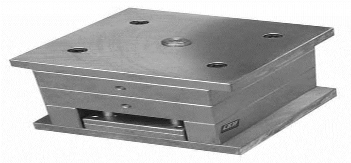
Figure III.1 : moule d'injection plastique
