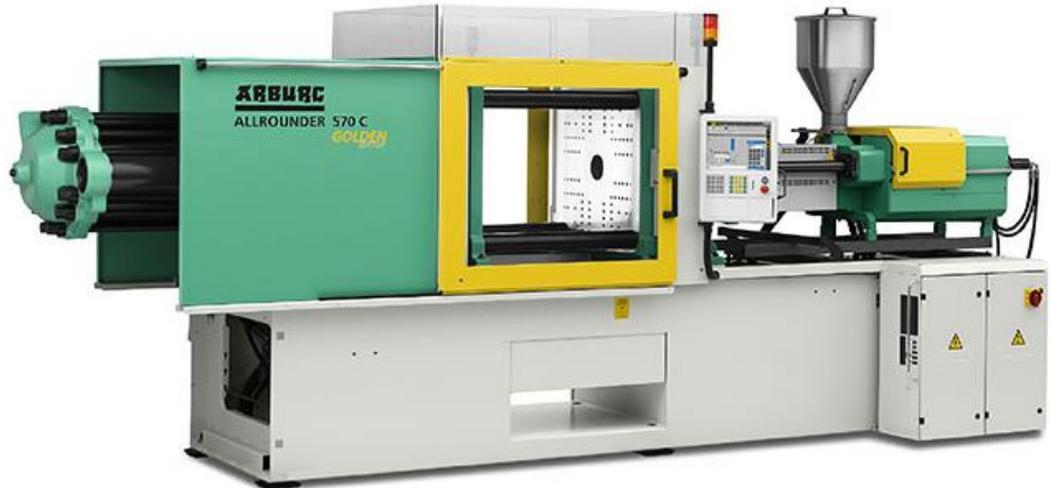
**Figure II.12** : Presse à injection plastique horizontale
