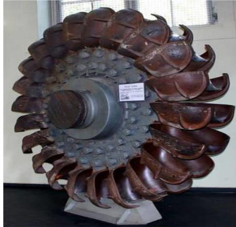
Figure II. 2: Roue d'une turbine Pelton
