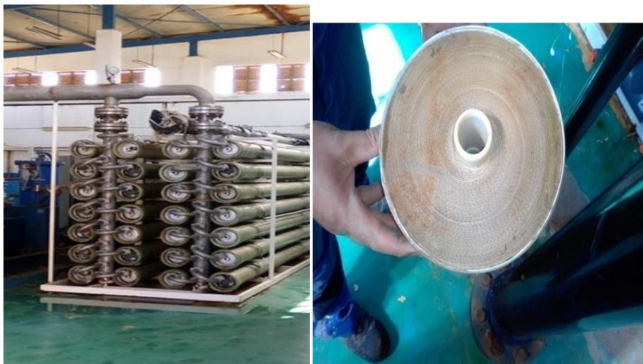
**Figure III.21 : Les tubes de pression et les membranes**
