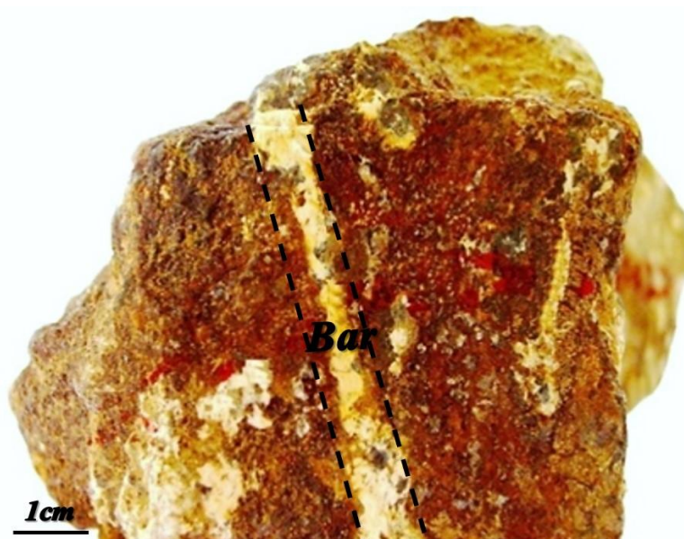
Figure 49: Veinule de barytine dans le calcaire Aptien
