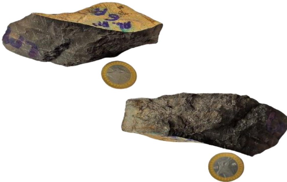
Figure 21: Photos montrant des échantillons du faciès marneux argileux de l'Albo-Aptien
