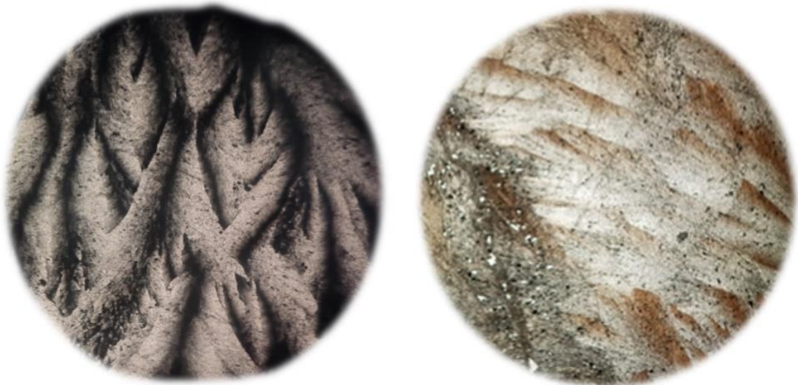
Figure 52: Barytine en éventail montrant une extinction roulante LM, LPA. G. x 10)
