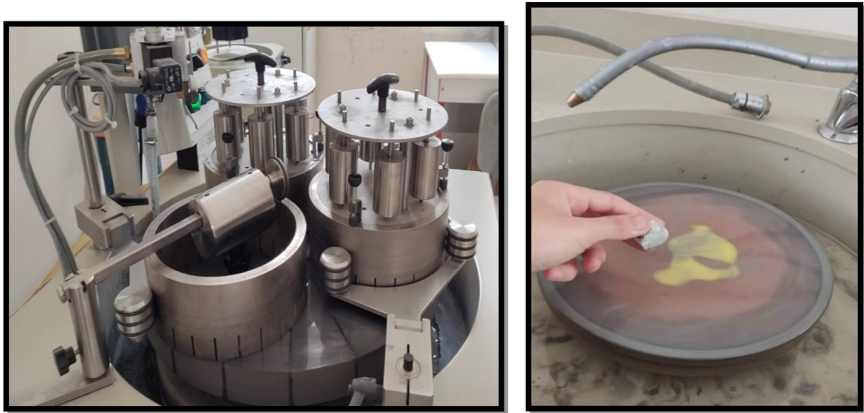
Figure 5 : Le rodage appelé aussi "le prépolissage"
