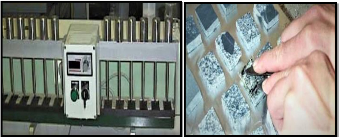
Figure 6: (A) Presse de collage chauffante. (B) Collage des lames de verre manuellement.
