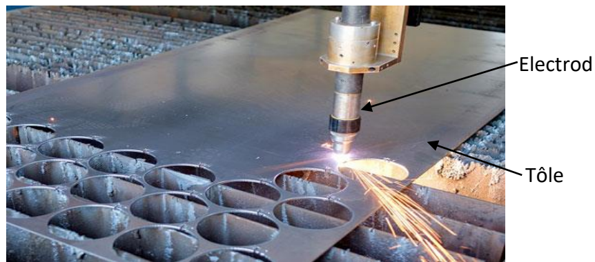
Figure II. 11: Exemple Découpe de tôles au plasma
