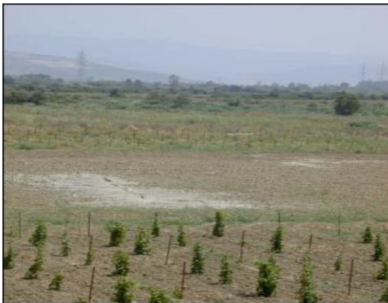
Figure 3.31 : Ebullitions de sable dues à la liquéfaction près de la rivière d'Isser (D'après le EERI, 2003, cité par HADDADENE Nacima 2008).
