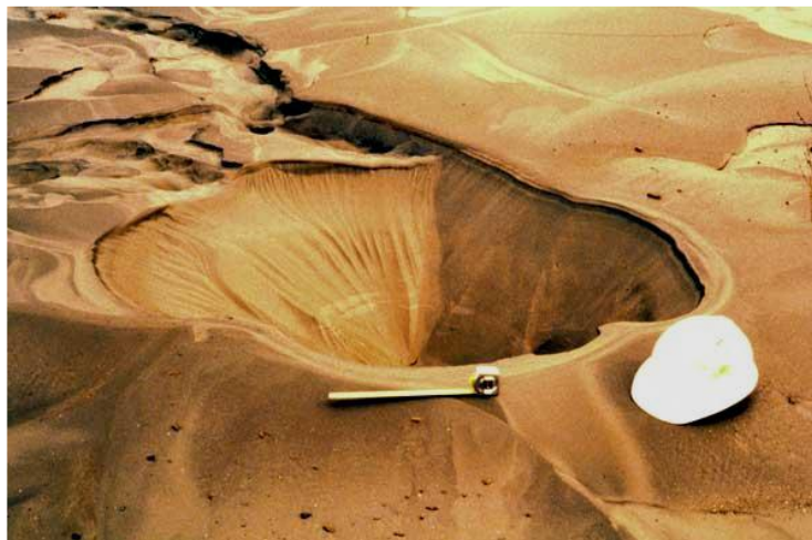
Figure 3.18 : Ebullition de sable à l'aéroport d'Oakland, le long du fleuve de Salina et à la station marine de Moss Landing (D'après Robert E. Kayen et al, 1998)
