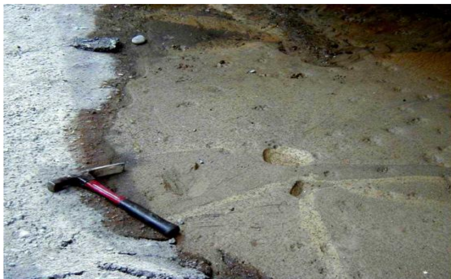
Figure 3.28 : Ebullition de sable en Turquie 1999 (d'après Peter M. Byrne et al, 2008).
