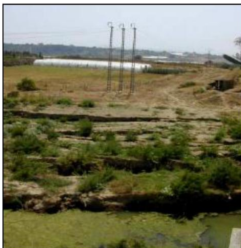
Figure 3.32 : Liquéfaction due à l'épandage latéral (D'après le EERI, 2003, cité par HADDADENE Nacima 2008)
