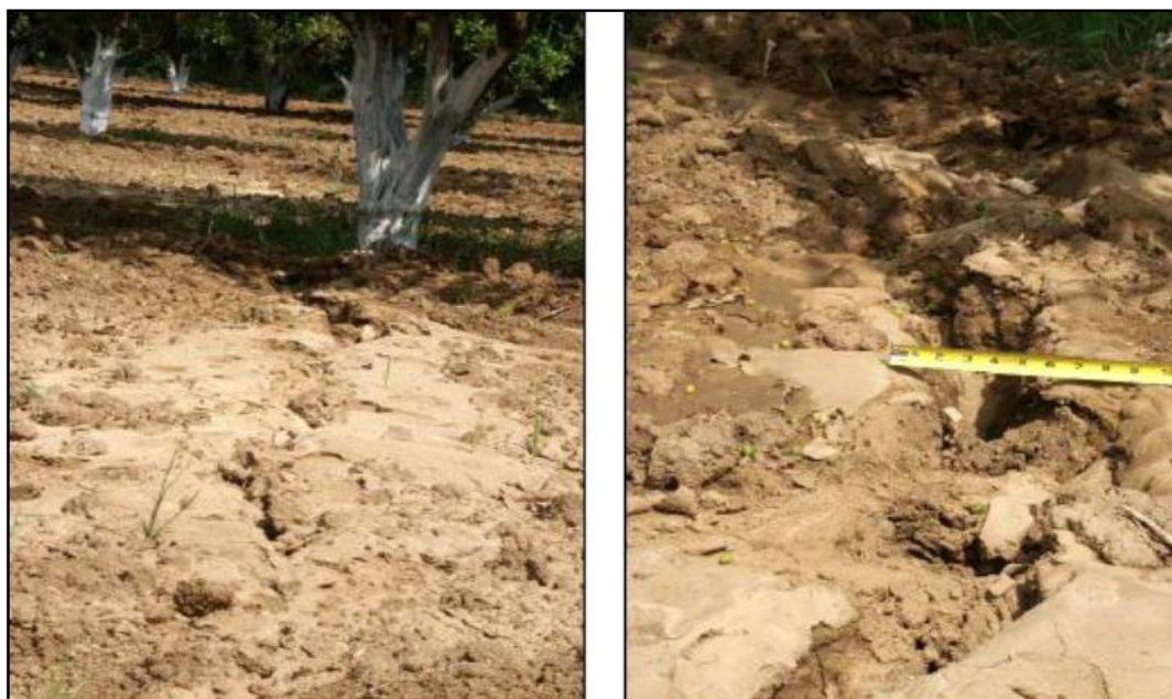
Figure 3.33 : Liquéfaction près de la ville de Zemmouri (ébullitions de sable). (D'après le EERI, 2003, cité par HADDADENE Nacima 2008).
