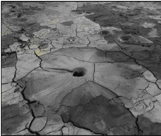
Figure 3.22 : Ebullitions de sable au Comté de Nantou (à gauche) et de Zhanghua (à droite) en Taiwan (d'après Dr Hsein, 2002).
