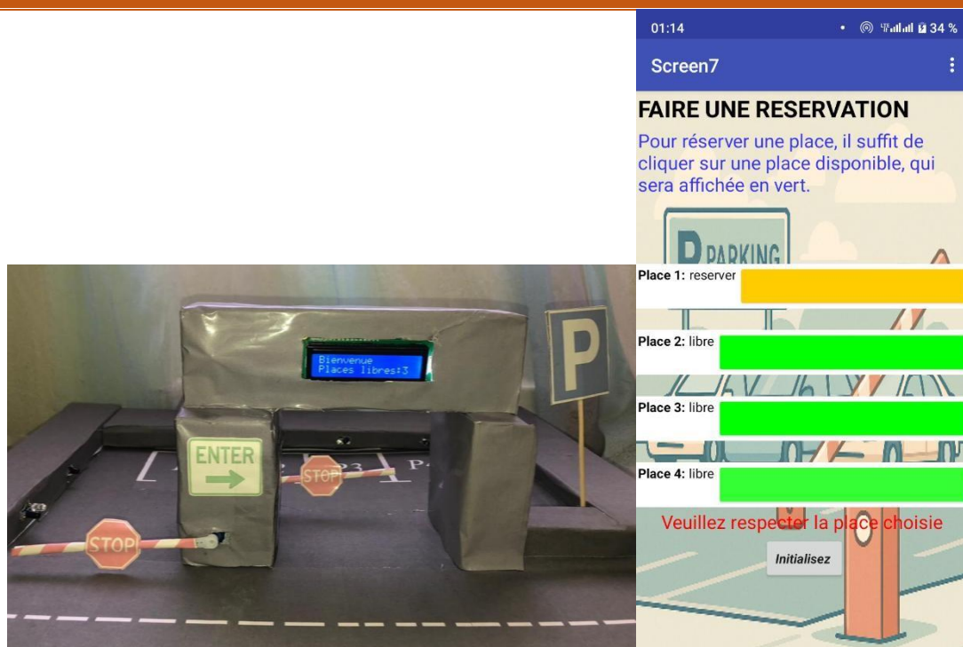
Figure III.45: Affichage sur la maquette et dans l’application — Après une réservation.
