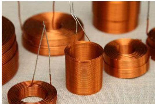
**Figure III. 4 : Capteurs inductifs constitués d'un fil de cuivre enroulé autour d'un noyau à air.**
