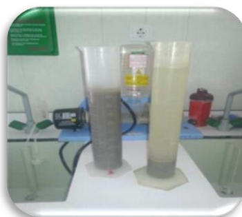
Figure 44 : Test de décantation
