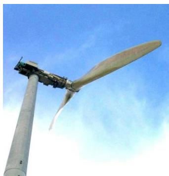
Rotor sous le vent (Vergnet 220 KW)
