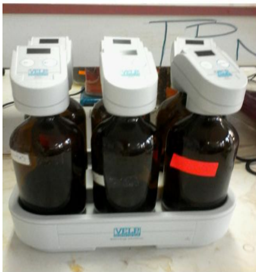
Dispositif expérimental OxiTop (DBO 5 )
