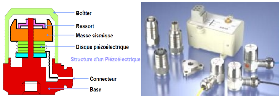
Figure I.7 : Coupe longitudinale d'un accéléromètre.
