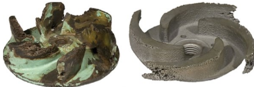
Figure II.36 : Effets de la cavitation sur les roues de pompe [02].
