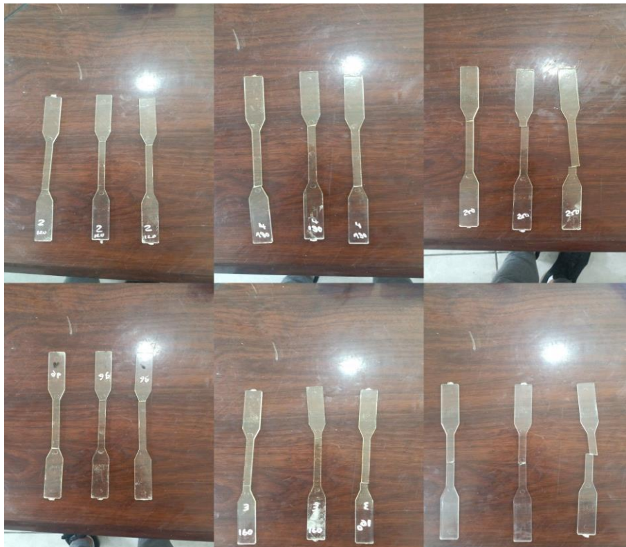
Figure N°V.8 : la rupture des éprouvettes.
