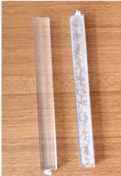
Figure N°VI.3 : comparaison entre une éprouvette normale et une éprouvette qui contient des bulles d'air.
