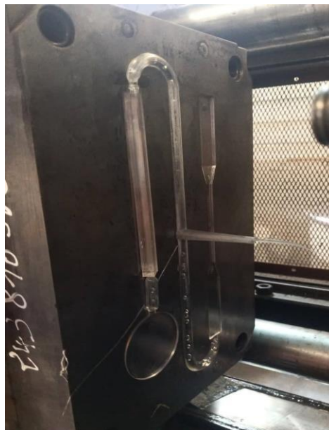
Figure N°IV.5 : la cavité de l'outillage.
