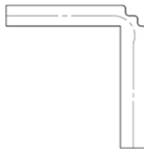
Figure II. 37 : Déformations à un angle vif ( R=0 ).
