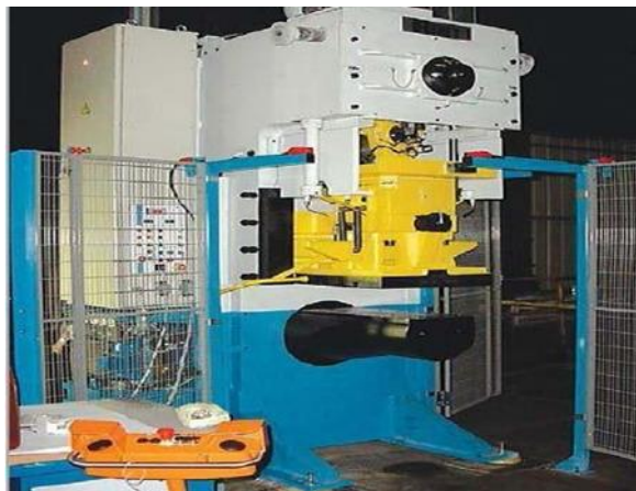
Figure III. 7 : Presse à table mobile et bigorne.
