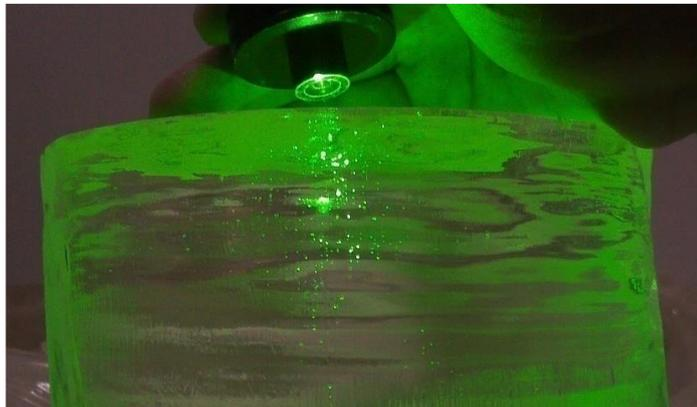
FIGURE 1.6 – La distribution des bulles dans un lingot de saphir obtenu par la méthode KY.
