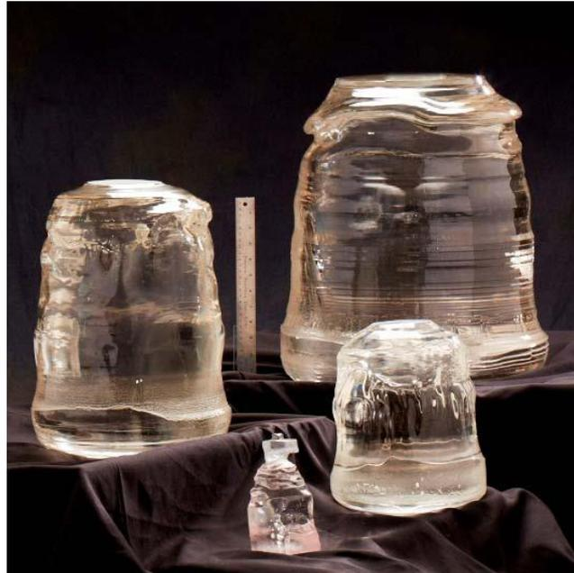
FIGURE 1.5 – Des lingots de saphir de 3 kg, 31 kg, 83 kg et 200 kg, développés par Rubicon Technology [9].
