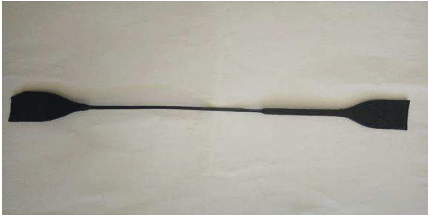
**Figure I-I-7 :** Eprouvette apres traction à un taux de déformation de plus de 100% .
