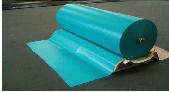
Figure II-4: geomembrane polychlorure de vinyle plastifié PVC P
