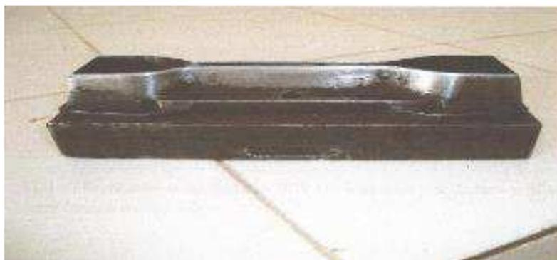
**Figure I-3** : moule utilisé pour la réalisation des éprouvettes
