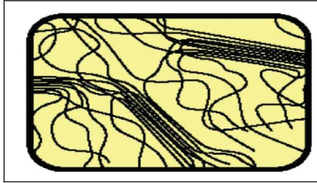
**Figure I-8:** polymère semi-cristallisé.
