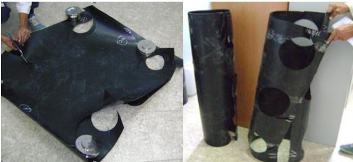
**Figure II.2. Découpage des éprouvettes pour poinçonnemnt.**
