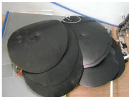
**Figure II.3. Eprouvettes pour l'essai de poinçonnement.**
