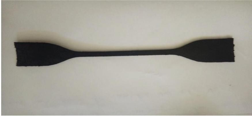
**Figure I-6 :** Eprouvette à l'état initial
