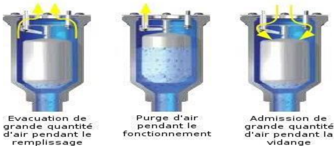
Figure VI.2. Schéma explicatif du fonctionnement d'une ventouse
